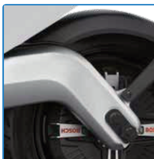
BRAS OSCILLANT EN ALUMINIUM ET TITANIUM
